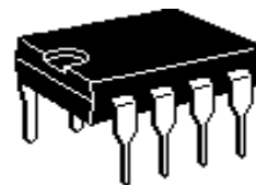
Корпус DIP-8 Типономинал K1224ПНЗР
